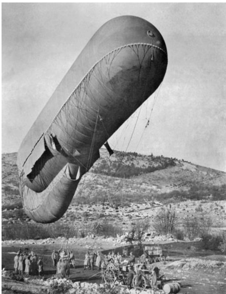
Upoutaný balon Parsevel-Sig-sfeld sloužil především k řízení střelby dělostřelectva. Byl plněn vodíkem a vojáka v proutěném koši pod balonem se zemí spojoval telefon. Tyto balony létaly i stovky metrů nad zemí a jedinou záchranou pozorovatele při sestřelení byl padák. Autor Jindřich Bišický.
